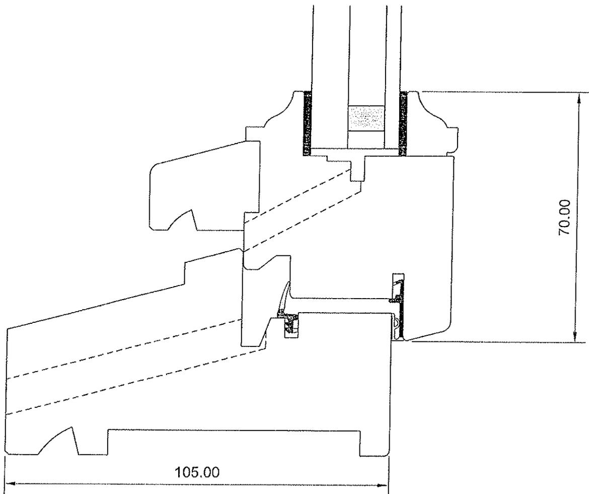
Menuiserie à recouvrement, double joint, 57 mm d'épaisseur
