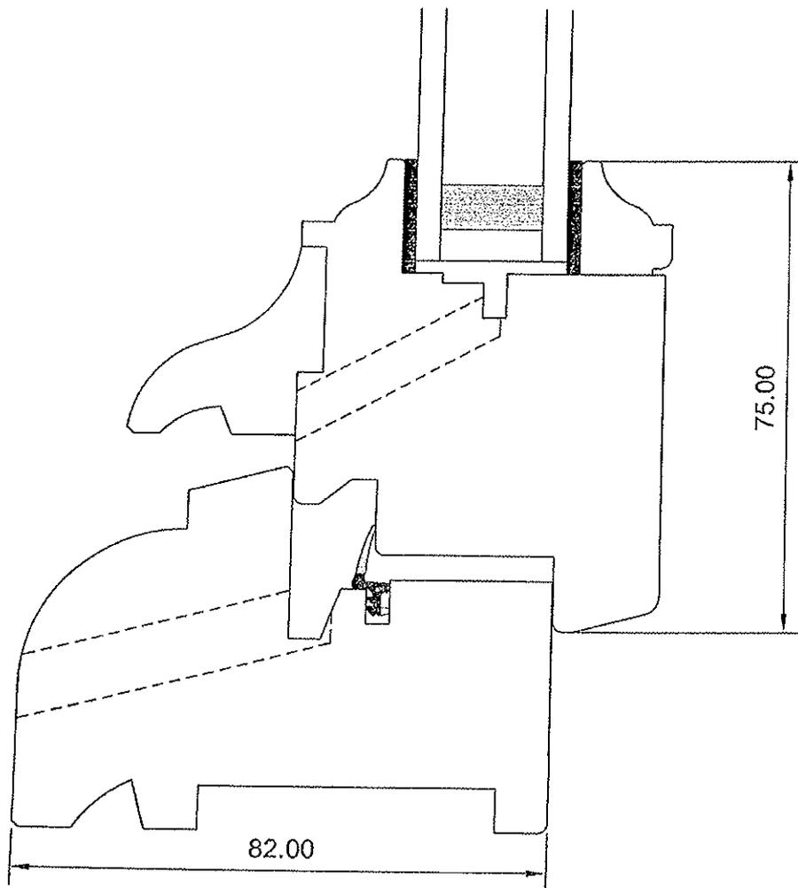
Menuiserie à recouvrement, simple joint, 57 mm d'épaisseur
