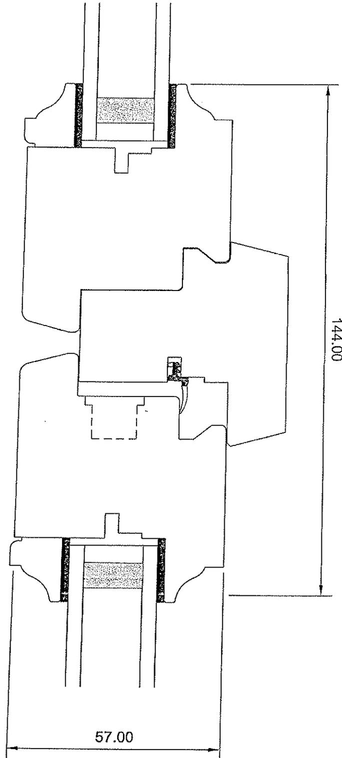
Menuiserie à recouvrement, simple joint, 57 mm d'épaisseur
