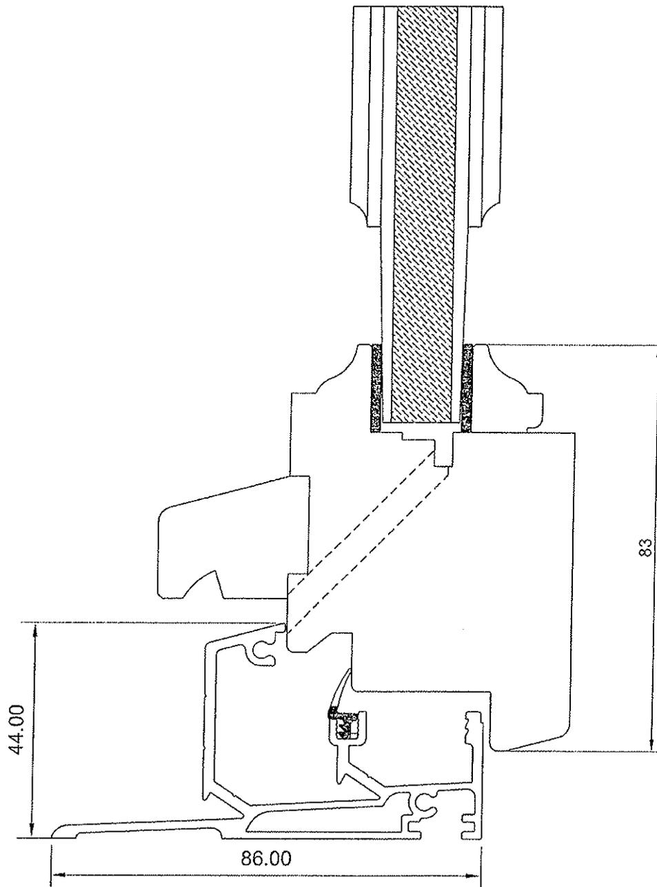
Menuiserie à recouvrement, simple joint, 57 mm d'épaisseur
