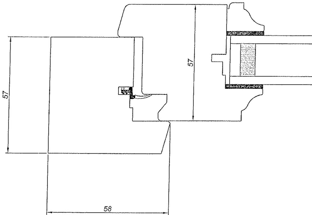
Menuiserie à recouvrement, simple joint, 57 mm d'épaisseur
