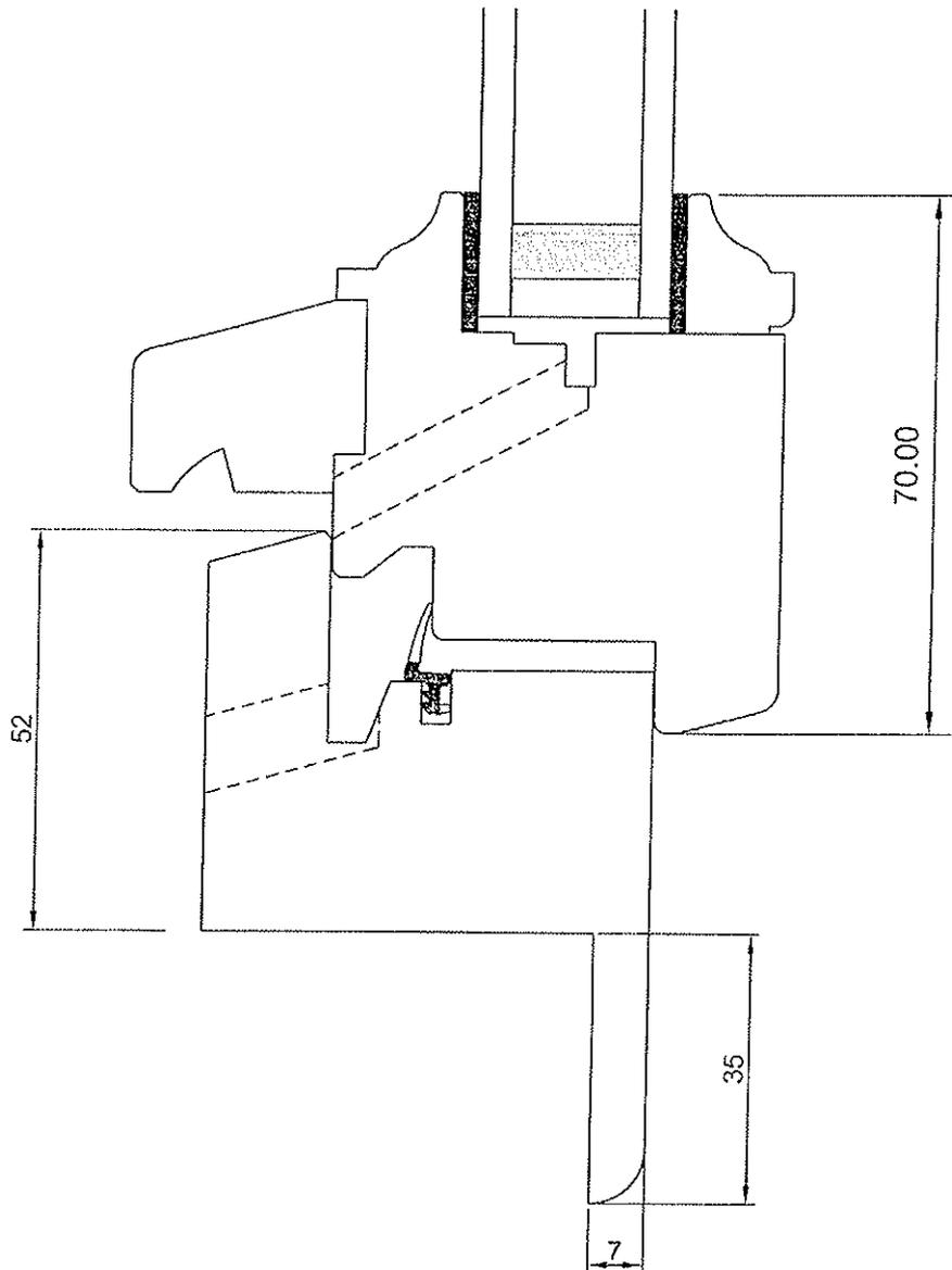
Menuiserie à recouvrement profil rénovation, simple joint, 57 mm d'épaisseur
