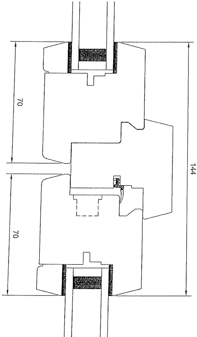
Menuiserie à recouvrement, simple joint, 57 mm d'épaisseur
