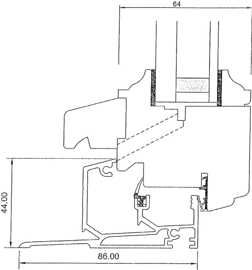
Menuiserie à recouvrement, double joint, 64 mm d'épaisseur
