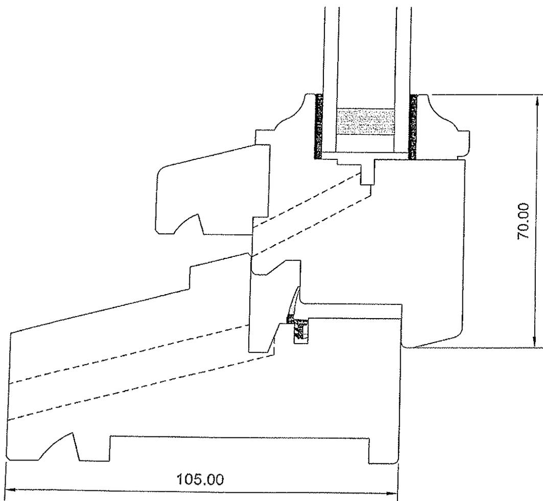
Menuiserie à recouvrement, simple joint, 57 mm d'épaisseur
