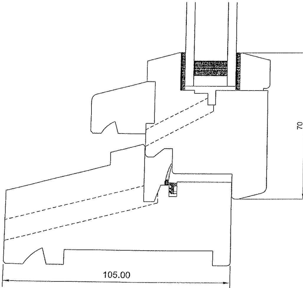
Menuiserie à recouvrement, simple joint, 57 mm d'épaisseur
