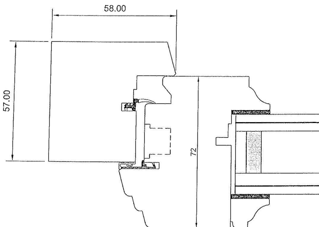
Menuiserie à recouvrement, double joint, 72 mm d'épaisseur
