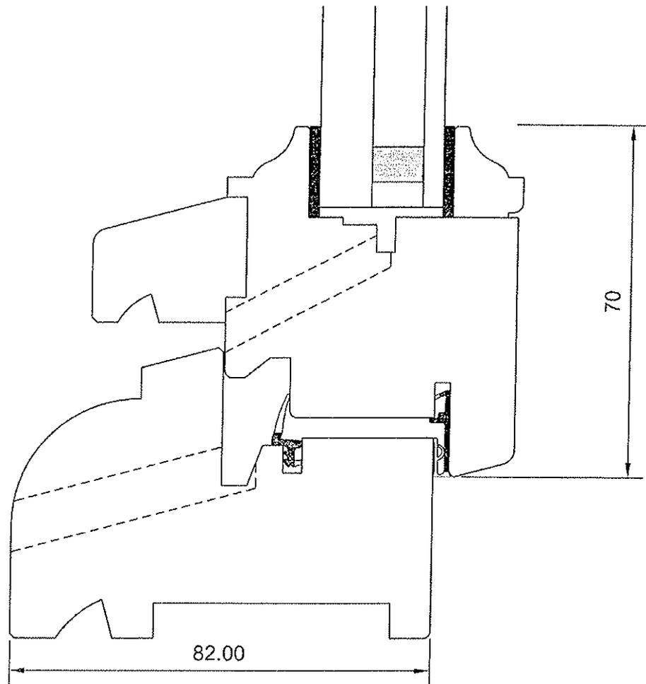
Menuiserie à recouvrement, double joint, 57 mm d'épaisseur
