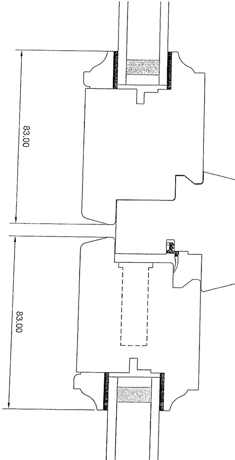
Menuiserie à recouvrement, simple joint, 57 mm d'épaisseur
