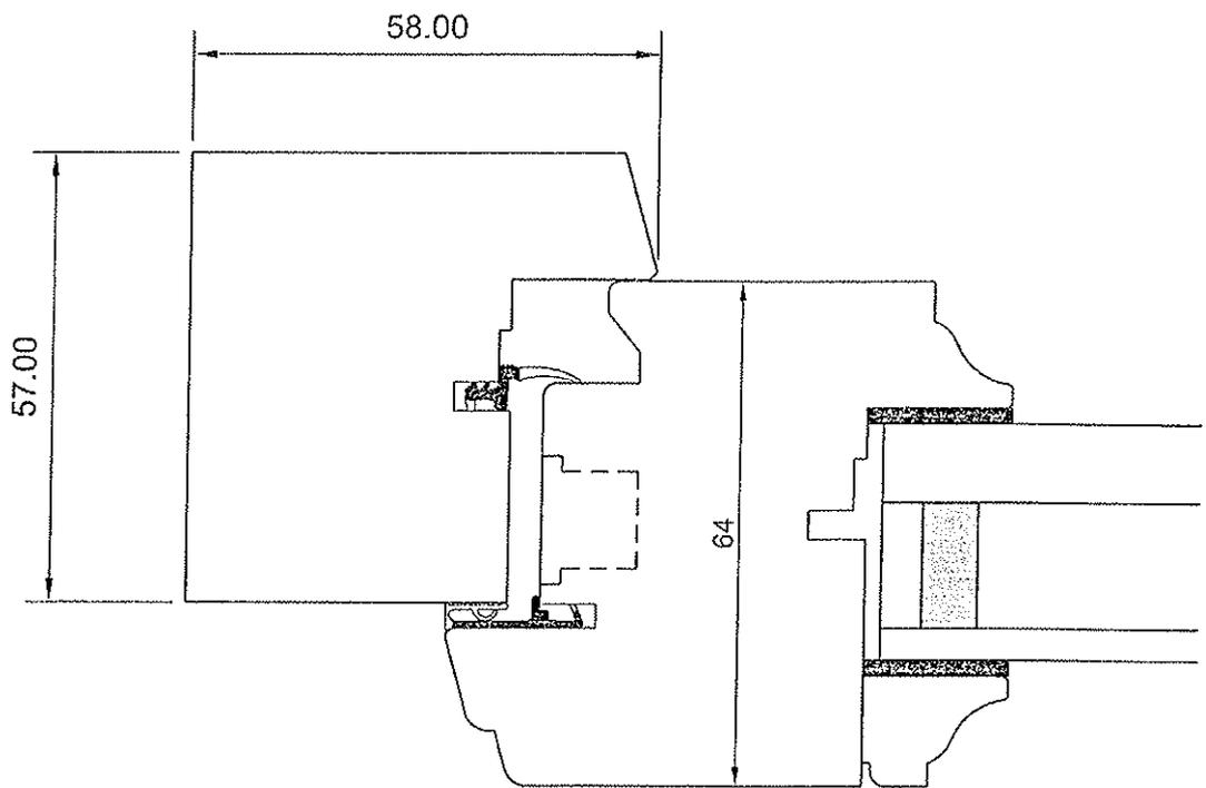
Menuiserie à recouvrement, double joint, 64 mm d'épaisseur
