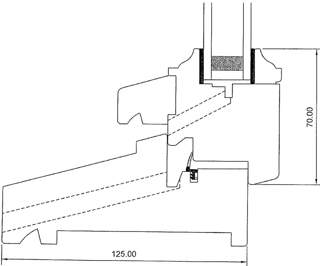
Menuiserie à recouvrement, simple joint, 57 mm d'épaisseur
