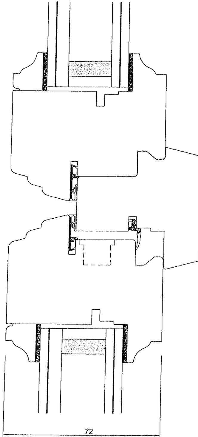
Menuiserie à recouvrement, double joint, 72 mm d'épaisseur
