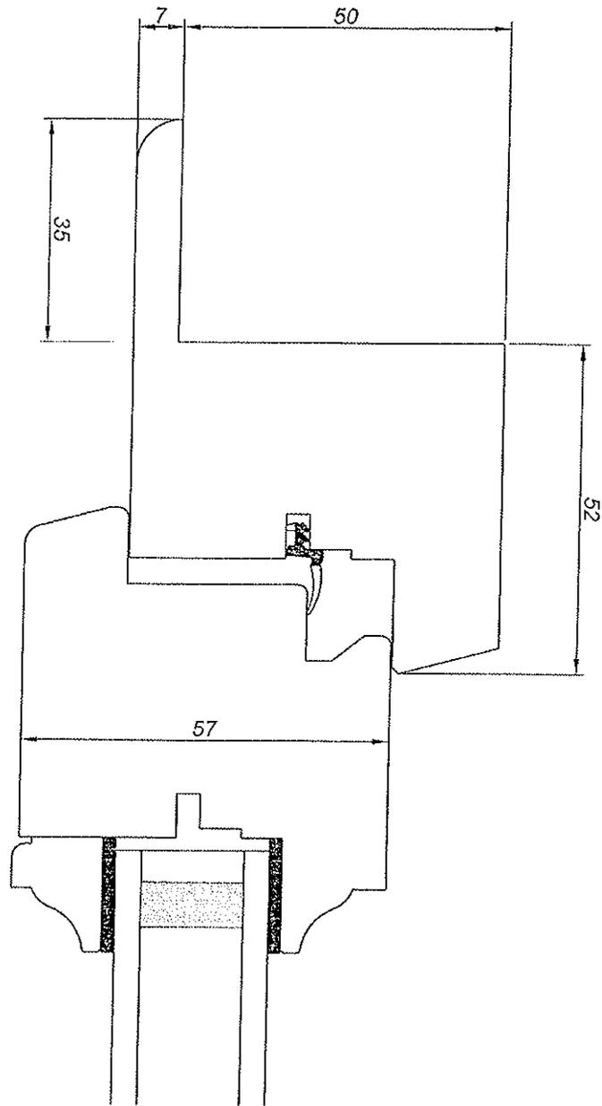
Menuiserie à recouvrement, simple joint, 57 mm d'épaisseur
