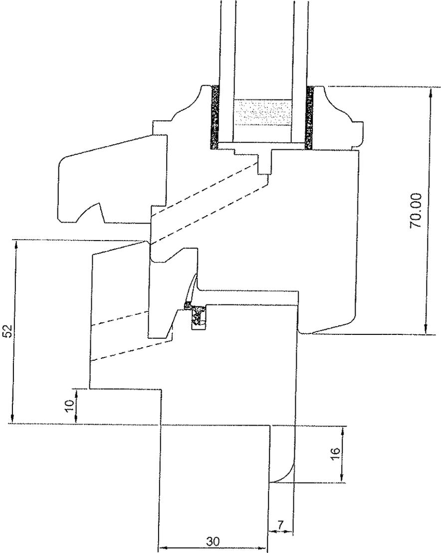
Menuiserie à recouvrement, simple joint, 57 mm d'épaisseur
