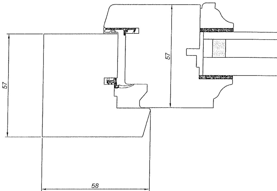
Menuiserie à recouvrement, double joint, 57 mm d'épaisseur
