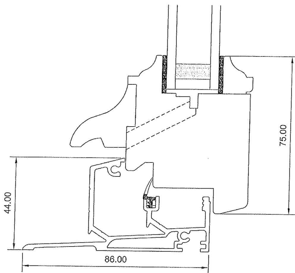
Menuiserie à recouvrement, simple joint, épaisseur 57 mm
