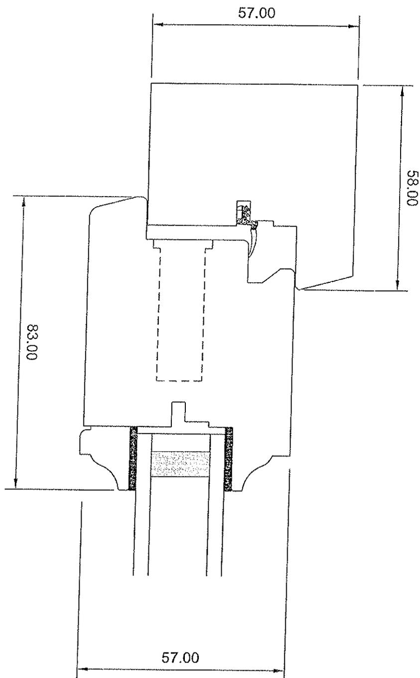
Menuiserie à recouvrement, simple joint, 57 mm d'épaisseur
