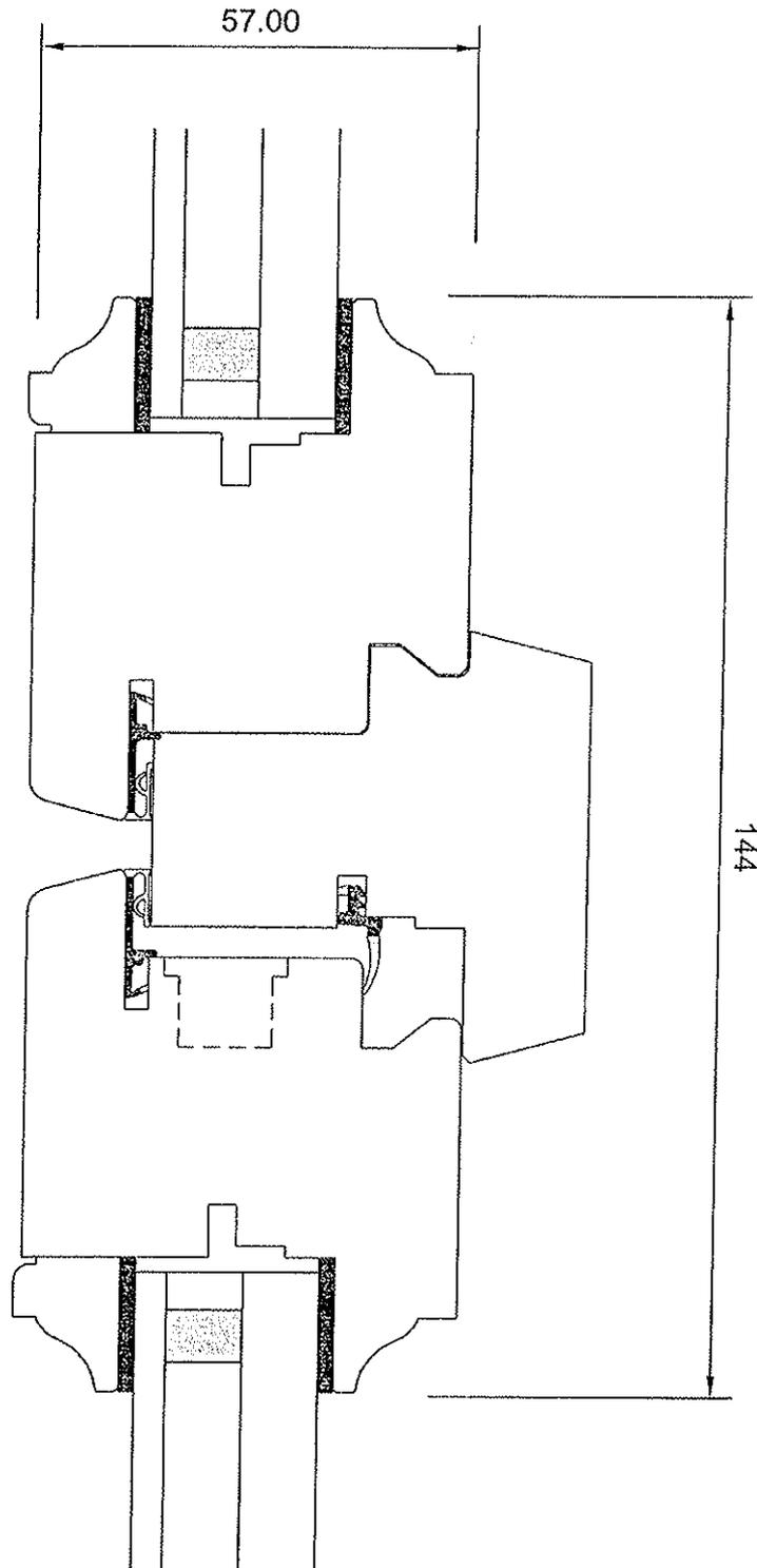
Menuiserie à recouvrement, double joint, 57 mm d'épaisseur
