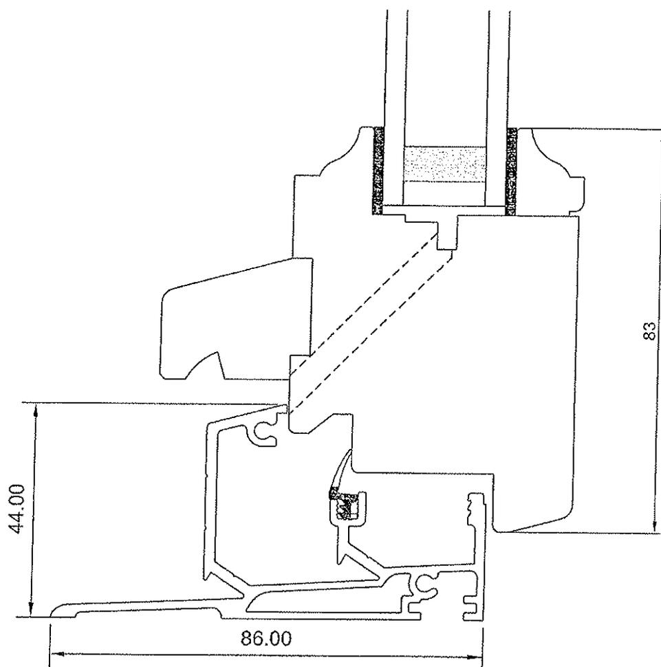
Menuiserie à recouvrement, simple joint, 57 mm d'épaisseur
