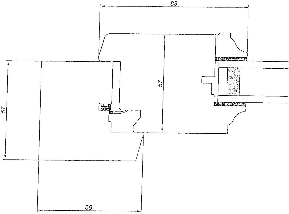
Menuiserie à recouvrement, simple joint, 57 mm d'épaisseur,
